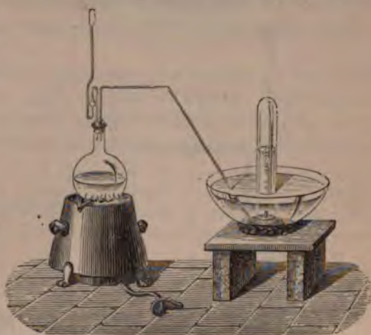
Fig. 24. — Préparation de l'oxygène par le chlorate de potasse.
